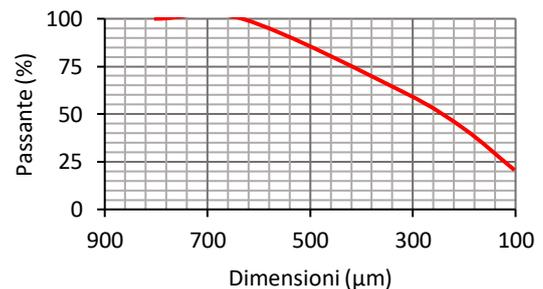
STRUMENTO DI MISURA: MALVERN MASTERSIZER3000E
